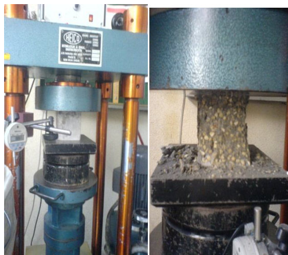
شکل (۲) آزمایش مقاومت فشاری و مدول الاستیسیته
