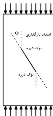
شکل (۱۰) زاویه بین امتداد نوک درزه و امتداد محور بارگذاری برای درزه صاف
