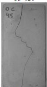
(ه) - درزه باز \beta=45^\circ , l=6\text{cm} s/b=0.31
