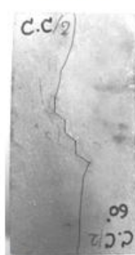
(د) - درزه بسته \beta=60^\circ , l=6\text{cm} s/b=0.38
