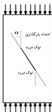
شکل (۱۰) زاویه بین امتداد نوک درزه و امتداد محور بارگذاری برای
