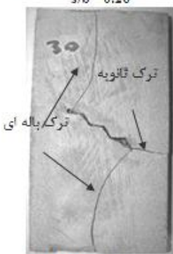
(و) - درزه باز \beta=30^\circ , l=5\text{cm} s/b=0.26
