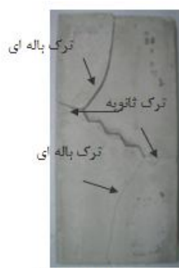
(الف) - درزه باز \beta=30^\circ , l=6\text{cm} s/b=0.25
