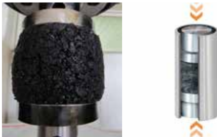
شکل ۴: روش ساخت و شکست نمونه‌ی آزمایش مقاومت فشاری
