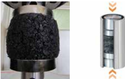
شکل ۴: طریقه ساخت و شکست نمونه‌ی آزمایش مقاومت فشاری
