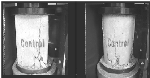
شکل (۷) بارگذاری نمونه‌های کنترل
