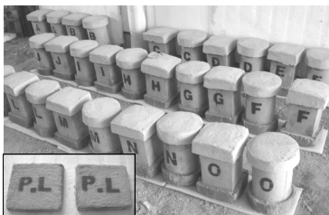
شکل (۵) نمای کلی نمونه‌ها با کلاهیک عایق و صفحات عایق
