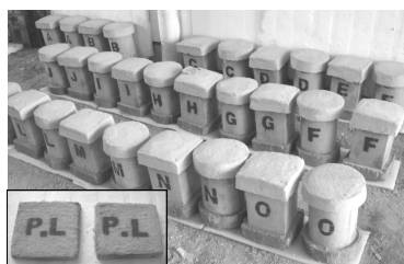
شکل (۵) نمای کلی نمونه‌ها با کلاهیک عایق و صفحات عایق
