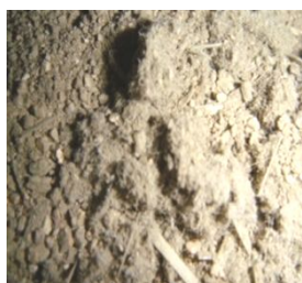
شکل (۴) پودر ضدحریق پایه سیمانی نوع 7GP
