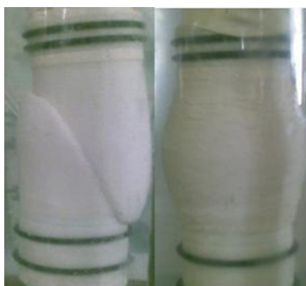
شکل (۹) دو نمونه‌ی ماسه‌ی بازسازی شده با روش A.P با دو روزنه‌ی مختلف پس از بارگذاری
