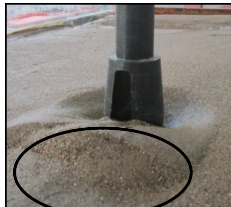
شکل (۱۱) تجمع رسوبات در پایین دست پایه و گرفتگی شکاف
