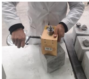
شکل ۱. آزمون کشیدن از سطح
