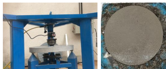
شکل ۵. روش تهیه و آزمون نمونه‌های خمشی
