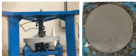
شکل ۵. روش تهیه و آزمون نمونه‌های خمشی
