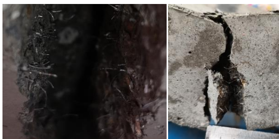
شکل ۱۰. پارگی الیاف تحت خمش در طرح WHSFSH-0%
