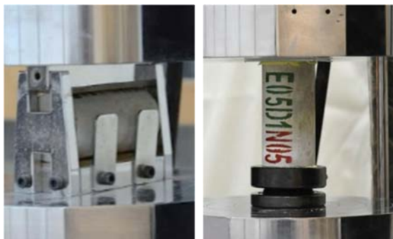
شکل ۹. (الف) نمونه‌ی تحت بارگذاری فشاری (ب) نمونه‌ی تحت بارگذاری کششی برزیلی
