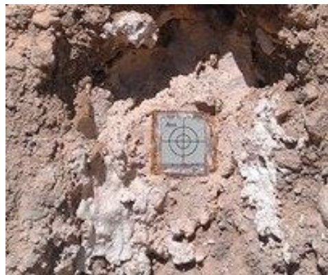
شکل (۴) نمونه‌ای از رفلکتور نصب شده روی جدار گود
