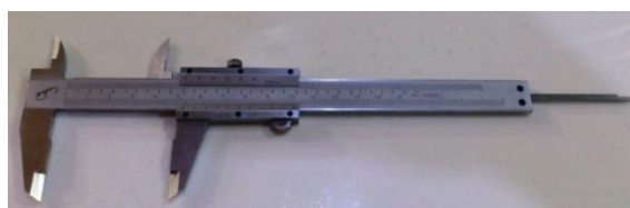
شکل (۱۲) کولیس استفاده شده برای ثبت تغییر طول نیروسنج
