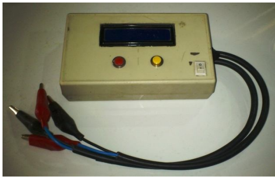
شکل (۸) دیتالاگر طراحی و ساخته شده در این تحقیق
