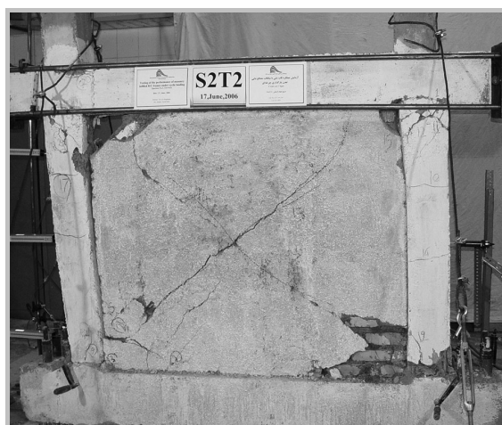
شکل ۶ نحوه شکست قابهای دارای میانقاب آجری
