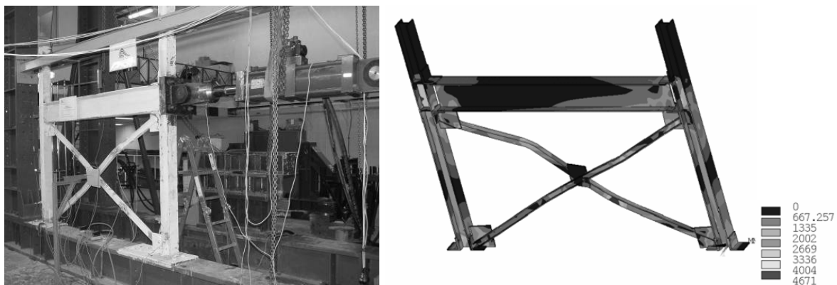
شکل (۱۷) توزیع تنش‌های فون میس برای نمونه تحلیلی و ریختن رنگ قاب ساده و قاب ساده با ورق اتصال مهاربند
