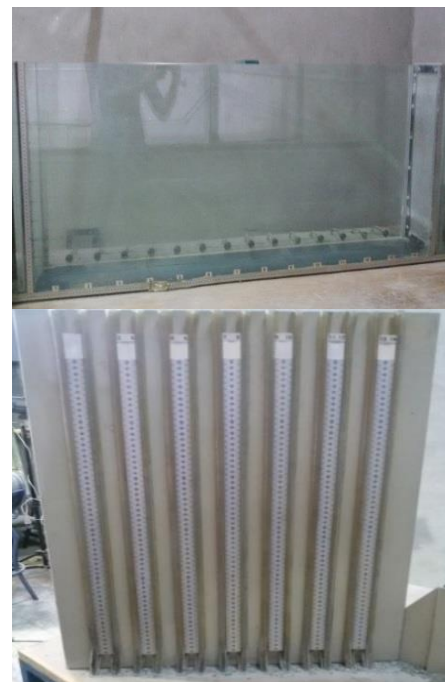
Fig. 1. Test box & Piezometer table
