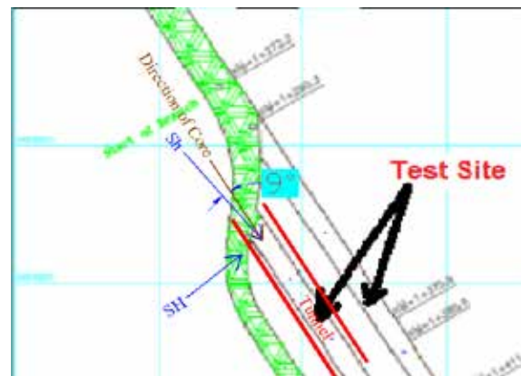
شکل ۷- شماتیکی از محور تونل و جهت تنش‌های افقی حاصل از آزمایش HF.
