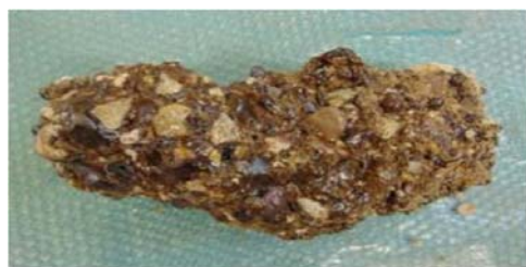
شکل ۵. نمونه F3 پس از آزمون مقاومت در برابر آتش
