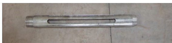
شکل (۲) نمونه‌گیر پنجره‌ای
