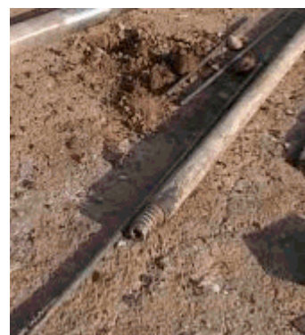
شکل (۴) یک میله نفوذ و سوزن آن
