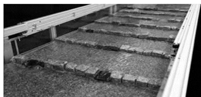
شکل (۶) نمای مدل فیزیکی از پایین‌دست با دبی سه لیتر بر ثانیه [۸]
