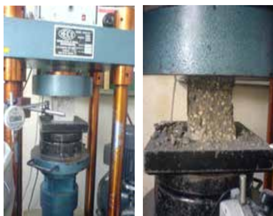
شکل ۲ آزمایش مقاومت فشاری و مدول الاستیسیته
