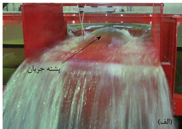
شکل (۴) نمایش پشته جریان در سرریز با زاویه انحنا \theta=180^\circ و نسبت H_0/P=0.68 : الف- نما از بالا ب- نما از روبرو
