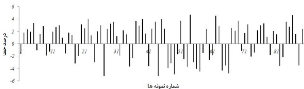
شکل (۸) درصد خطای مقادیر پیش‌بینی شده توسط شبکه عصبی با مقادیر به‌دست آمده از اجزای محدود (تیر کنسول)
