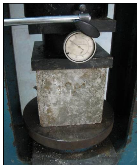
شکل (۱۵) انجام آزمایش مقاومت تک محوری بتن
