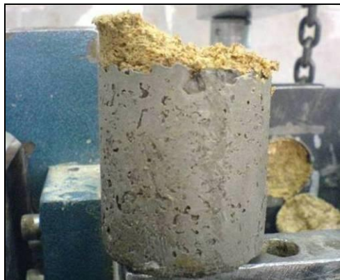
شکل (۱۰) نمونه لوماشل بعد از آزمایش
