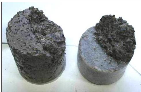
شکل (۹) نمونه مرمر بعد از آزمایش
