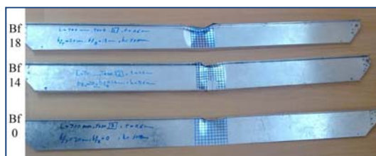
شکل (۹) نمونه‌های تغییر شکل یافته در پایان آزمایش
