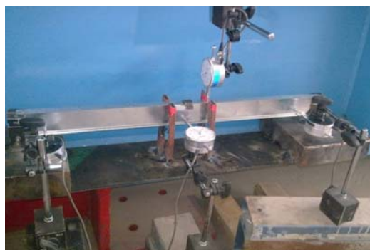
شکل (۸) طرح آزمایش همراه با قاب بارگذاری و محل قرارگیری حسگرهای تغییر مکان
