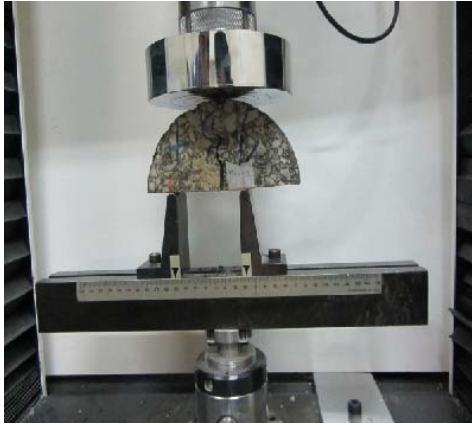
شکل ۷- نمونه SCB ساخته شده از بتن آسفالتی تحت بارگذاری خمش سه نقطه‌ای.
