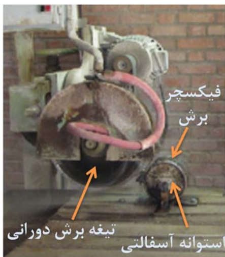
شکل ۶- چگونگی برش نمونه استوانه‌ای آسفالتی با دیسک گردان
