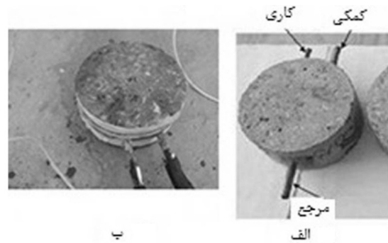
شکل (۱) الف) نمونه‌های بتنی بعد از برش ب) طریقه اعمال ۳۸۰ ولت متناوب
