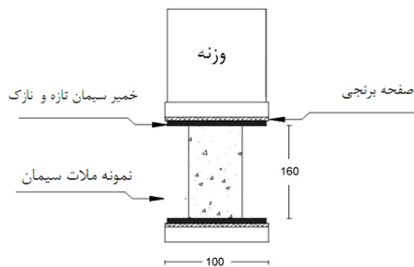
شکل (۴) چگونگی آماده سازی نمونه برای اندازه‌گیری مقاومت الکتریکی ملات سخت شده
