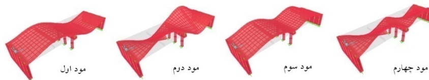
شکل (۱۱) اشکال مودی حاصل از تحلیل مدل اجزای محدود پل جدید
