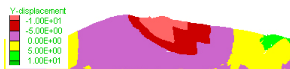
شکل (۷) تغییر مکان قائم (متر) سد قرار گرفته بر پی اول در شتاب 0.5g
