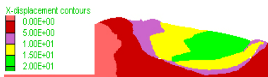
شکل (۶) تغییر مکان افقی (متر) سد قرار گرفته بر پی اول در شتاب 0.5g
