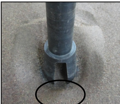
شکل (۱۲) تشدید فرسایش بستر در لبه‌های شکاف
