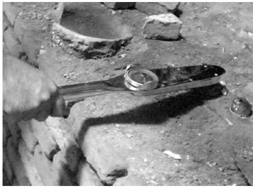
شکل ۴ تعیین مقاومت ملات ساروج نمای داخلی یک حمام قدیمی در دست مرمت با روش «پیچش»
