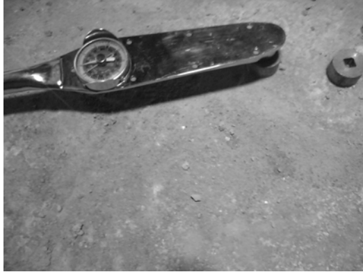
شکل ۳ تعیین مقاومت سنگ کف یک سازه قدیمی با روش «پیچش»
