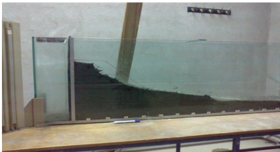
شکل ۷. گسیختگی شیروانی پس از ۵۰ دقیقه در اثر بارش مصنوعی در مدل اول
