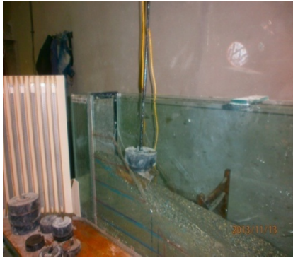
شکل ۱۰. گسیختگی در مدل دوم تحت فشار ۳/۱۲ کیلوپاسکال
