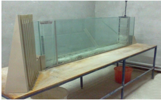
شکل ۱. جعبه آزمایشگاه و تابلوی پیزومتر جهت ساختن مدل
