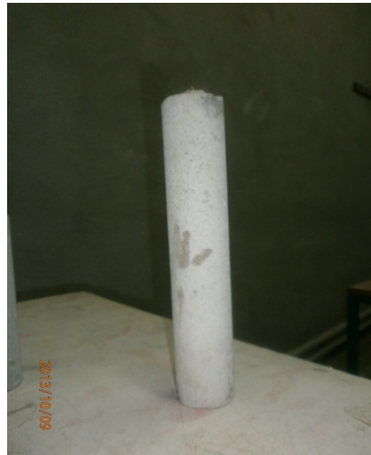
شکل ۳. شمع بتنی مورد استفاده در مسلح سازی شیب
