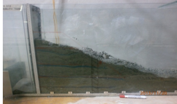
شکل ۱۲. گسیختگی مدل چهارم تحت فشار ۱۰/۹ کیلوپاسکال
