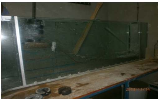
شکل ۱۱. گسیختگی در مدل سوم تحت فشار ۷/۸ کیلوپاسکال
