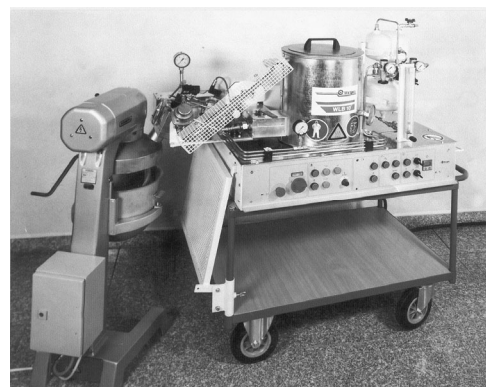
شکل ۲ دستگاه آزمایشگاهی تولید کف قیر (WLB10)
