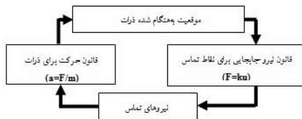
شکل (۲) الگوریتم محاسباتی روش اجزاء مجزا (DEM) [۷]
