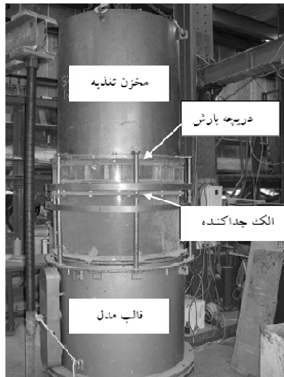
شکل (۲) دستگاه نمونه‌ساز به روش باران ماسه، به کار رفته در این پژوهش
