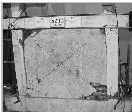
شکل ۶ نحوه شکست قابهای دارای میانقاب آجری
