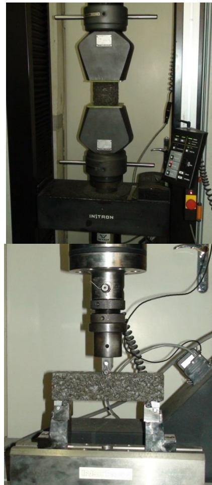
شکل (۲) تصویری از دستگاه مورد استفاده برای آزمایش فشاری و خمشی
