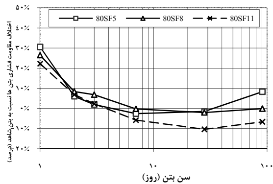
شکل (۴) توسعه مقاومت فشاری بتن ۸۰ حاوی میکروسیلیس
