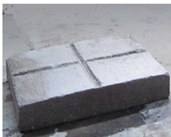
شکل (۱) الف: تصویر بتن پایه با شاخص قید ۰/۱۳
