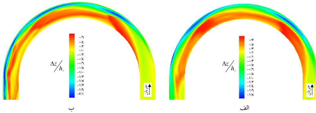
شکل ۱۱ بررسی تأثیر شبکه‌بندی بر تغییرات تراز بستر ( \Delta z/h_0 )
