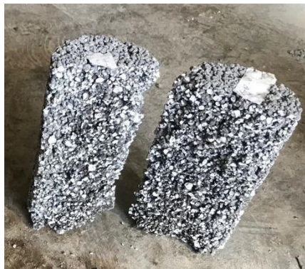
Fig. 1. Fractured specimen in splitting tensile strength تعیین جذب آب نمونه‌ها طبق استاندارد ASTM C642 [35] انجام شد. به دلیل تخلخل بالای بتن نفوذپذیر و حضور
