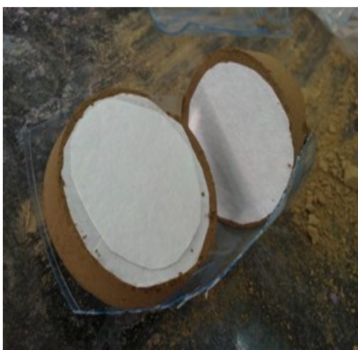
شکل (۳) چگونگی قرارگیری فیلتر کاغذی در روش مستقیم
