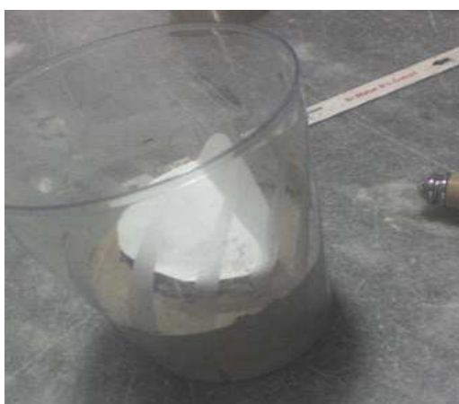
شکل (۴) چگونگی قرارگیری فیلتر کاغذی در روش غیرمستقیم
