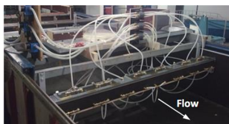
شکل ۲ (الف) جزئیات فلوم آزمایشگاهی و تعریف پارامترهای هندسی، (ب) چگونگی قرار گیری دوربین ها در محدوده میدان آبشکن، (ج) ذرات ردیاب مورد استفاده و (د) دستگاه پخش ذرات.
