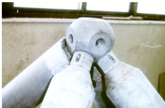
شکل (۲) گسیختگی جوش لوله و قطعه مخروطی انتهایی در آزمایش‌های اولیه
