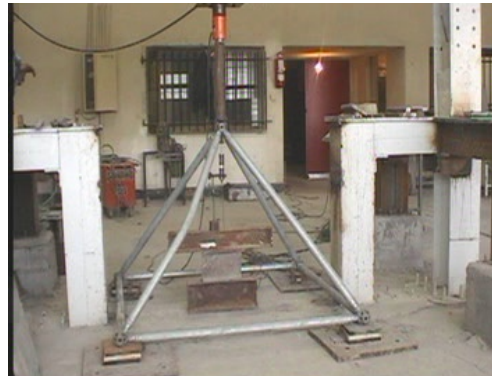
شکل (۳) نمونه‌ای از نحوه وقوع کمانش در مدول‌های مورد آزمایش
