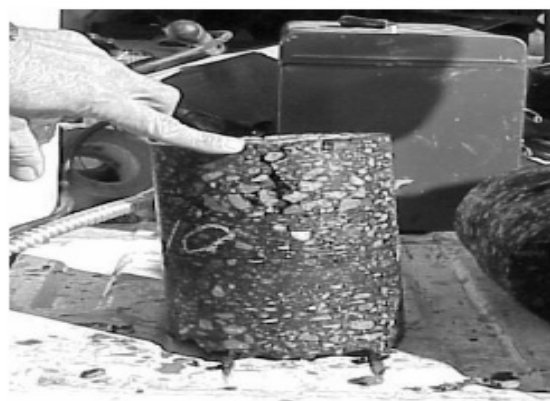
شکل ۱ ترک‌خوردگی از بالا به پایین در یک نمونه‌ی آسفالت [۴]
