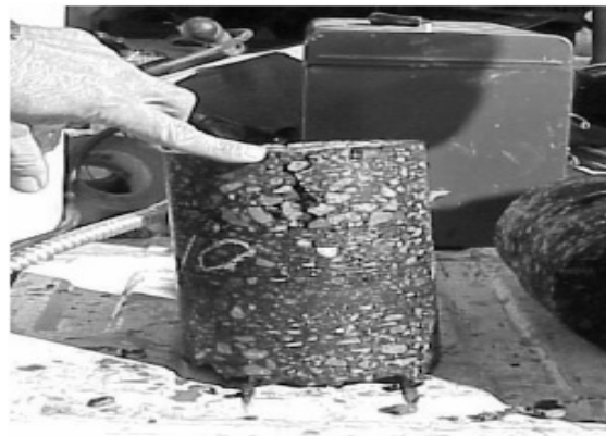
شکل ۱ ترک‌خوردگی از بالا به پایین در یک نمونه‌ی
