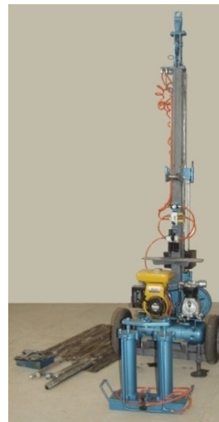
شکل (۱) دستگاه کاوشگر دینامیکی موتور دار ساخته شده در این تحقیق و سایر ملحقات آن
