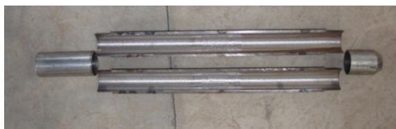
ر) نمونه‌گیر در حالت باز شده بدون مخروط نوک
