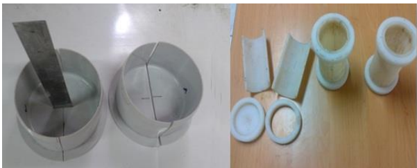
شکل ۴. قالب‌های PVC برای ساخت نمونه‌های CSCBD و نمونه‌های آزمایش مقاومت تک محوری.
