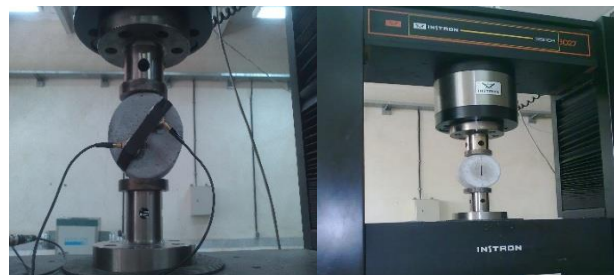
شکل ۷. دستگاه بارگذاری به همراه سنسورهای سیستم ثبت امواج
