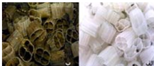
شکل ۷- (الف) قبل و (ب) بعد از تشکیل بیوفیلیم بر روی آکنه‌های K 1 در سیستم MBBR
