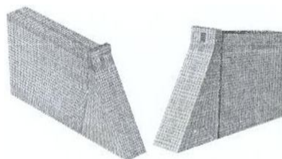
شکل (۲) نمای سه بعدی از مدل‌سازی و نحوه مش‌بندی سامانه سد و مخزن و دریچه
